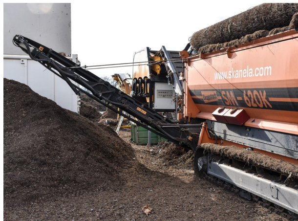
Krossning och siktning av trädgårdsavfall vid Hagby återvinningscentral, maj 2020.
